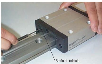
4. Si el juego ajustado es tan estrecho que el carro guía se atasca, no basta con volver a poner en su sitio solamente el tornillo con hembra hexagonal. Tras desenroscar, accione también el botón de reinicio situado en el lado contrario al de los tornillos para aflojar de nuevo los elementos corredizos. Para ello, utilice una espiga del tamaño siguiente:
